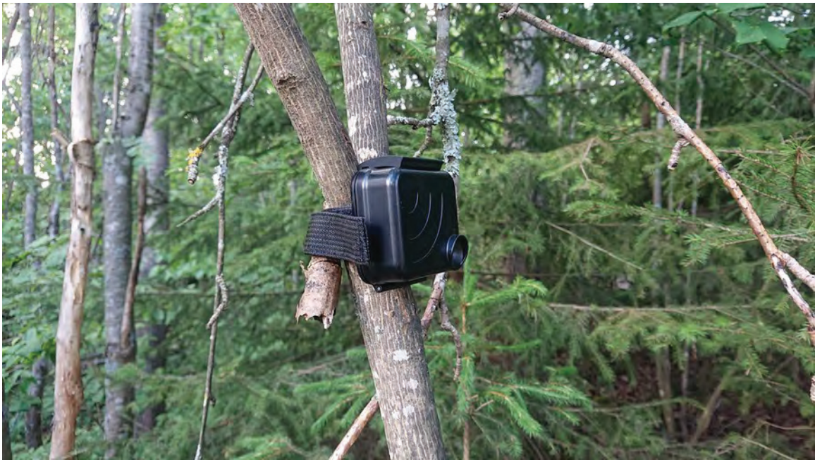
Kuva 4. Audiomoth passiiviseurantalaite suojakotelossaan Linnainmaalla varten © Timo Metsänen
